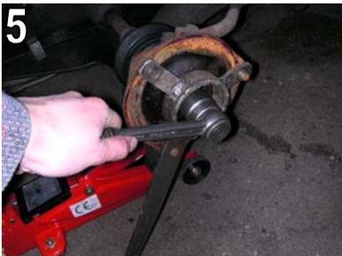
← ❺ Dévissez l'écrou de 32 ; vous aurez peut-être besoin d'allonger le bras de levier. Empêchez la flasque de tourner grâce à la clé de maintien, ou glissez un axe dans les ajourages de la flasque s'ils existent.
