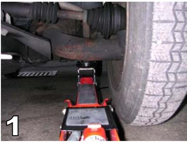
← ❶ Soulevez la roue du cardan sur lequel intervenir. Un cric hydraulique placé sous le bras de la roue est idéal. A défaut, utilisez le cric d'origine comme indiqué par Citroën. N'oubliez pas de mettre une cale derrière la roue opposée.
